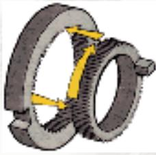
Zusätzliche Sicherheit: Wird der Geheimcode entdeckt, kann man im Getriebe alle vier Räder auf eine neue Kombination einstellen.
