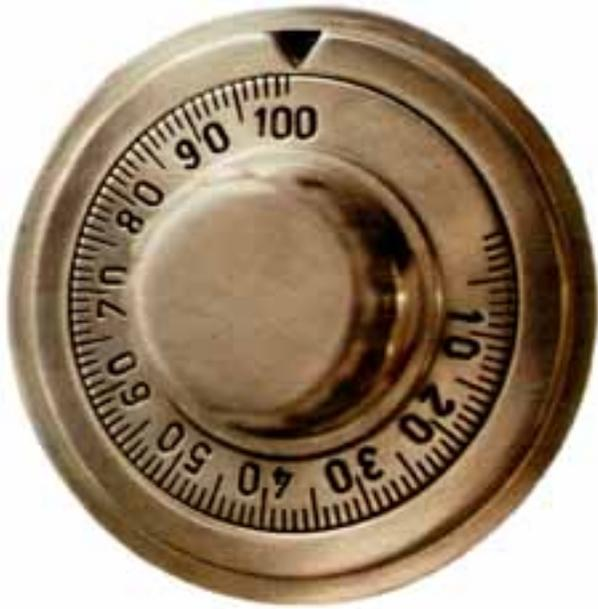
**100 Millionen Kombinationsmöglichkeiten werden mit einer einzigen Wählscheibe gesteuert.** Auf der Scheibe ist nur eine Hunderterskala zu sehen. Wie man damit eine achtstellige Zahl anwählen kann, dieses Geheimnis steckt im komplizierten Getriebe des Tresorschloßes.
